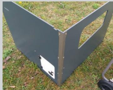
Verschrauben Sie die hintere Wand mit der linken Seitenwand mit den **Schrauben 10** und **Muttern 3**.
